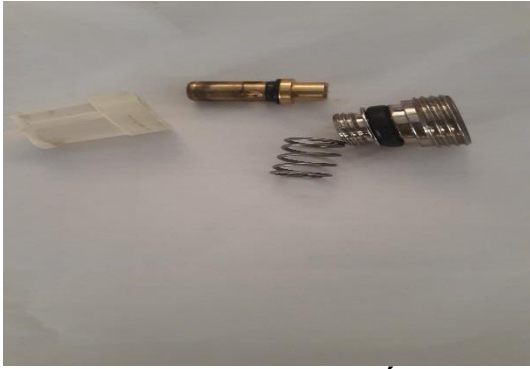
Hình ảnh cấu tạo lõi bên trong và các vòng ron thay thế
