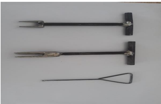
Hình ảnh bộ dụng cụ tự chế để mở các ngõ ra khí trung tâm trên tường tại các khoa
