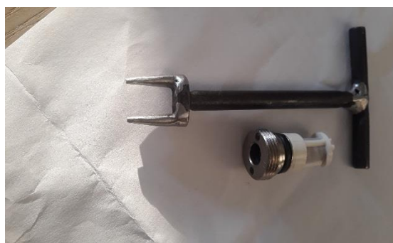
Hình ảnh bộ dụng cụ tự chế để mở các ngõ ra khí trung tâm trên tường tại các khoa
