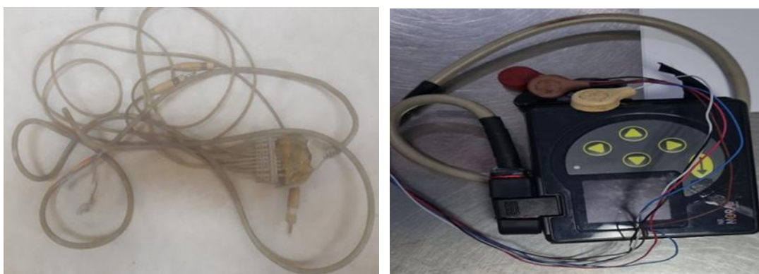
Hình ảnh dây dùng để thay thế và bộ dây điện cực sau khi đã làm lại
