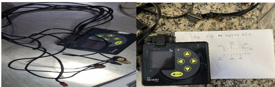
Hình ảnh bộ dây điện cực lúc chưa thay và sơ đồ cấu tạo, kết nối giữa các chân của giắc
